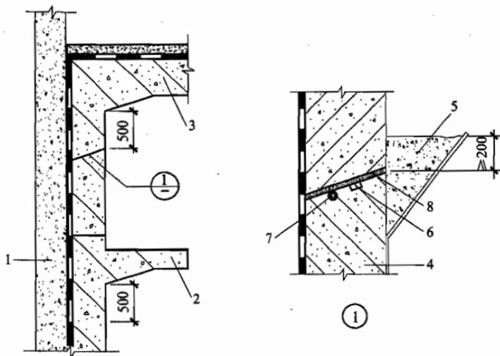
图 8.4.2 逆筑法施工接缝防水构造
