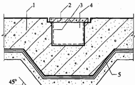
图 5.8.2 底板下坑、池的防水构造
