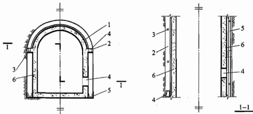
图 6.2.13 离壁式衬砌排水构造
