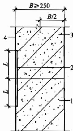
图 4.1.25-2 施工缝防水构造(二)
