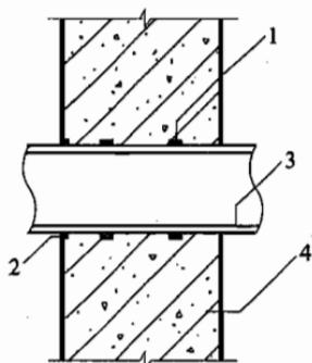
图 5.3.3-2 固定式穿墙管防水构造(二)
