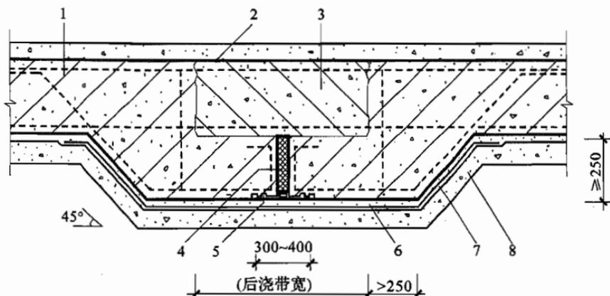
图 5.2.14 后浇带超前止水构造
