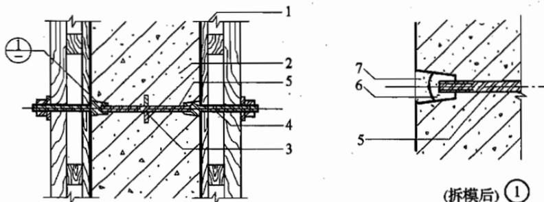
图 4.1.28 固定模板用螺栓的防水构造
