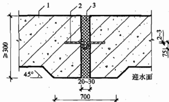
图 5.1.7 中埋式金属止水带
