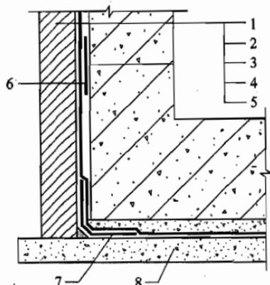
图 4.4.5-2 防水涂料外防内涂构造
