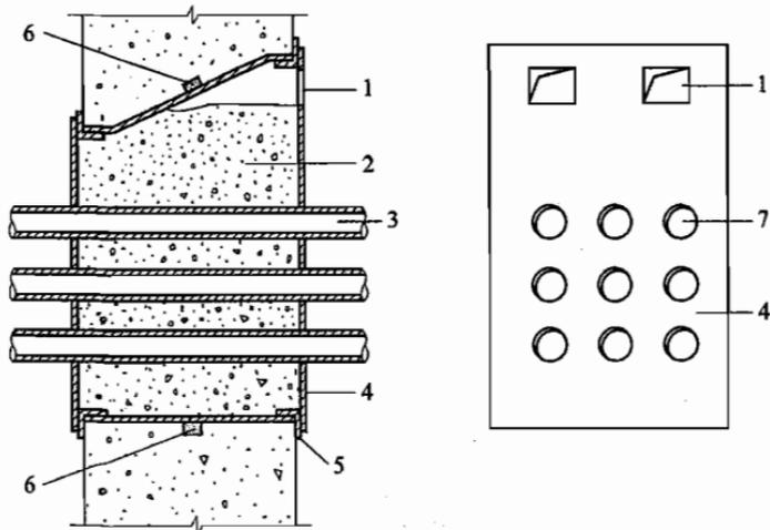
图 5.3.6 穿墙群管防水构造
