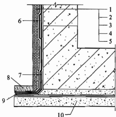
图 4.4.5-1 防水涂料外防外涂构造
