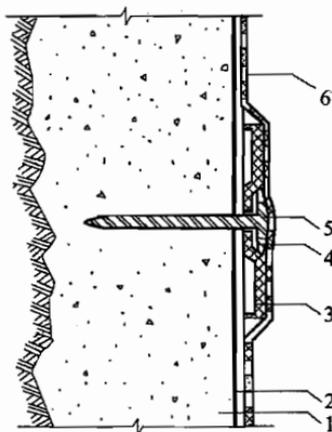
图 4.5.12 暗钉圈固定缓冲层
