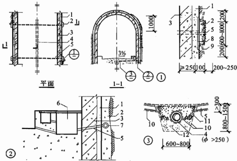
图 6.2.12 贴壁式衬砌排水构造
