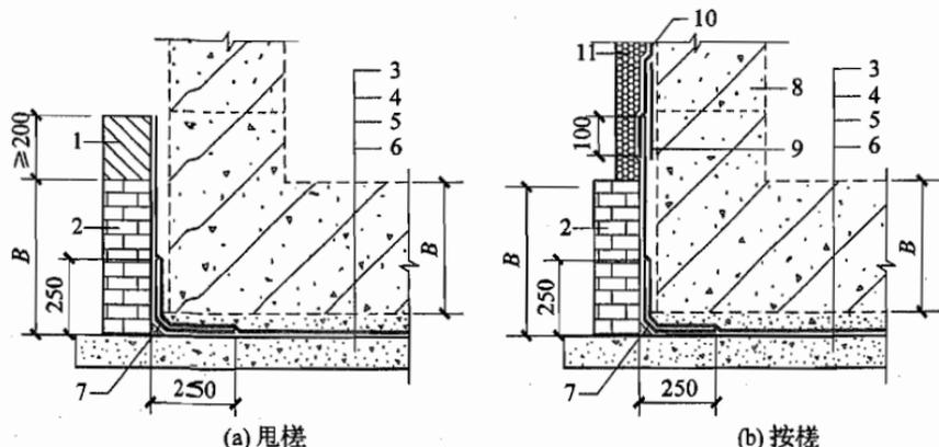
图4.3.23 卷材防水层甩槎、接槎构造
