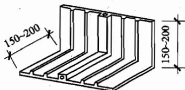
图 5.1.12-2 外贴式止水带在转角处的直角配件
