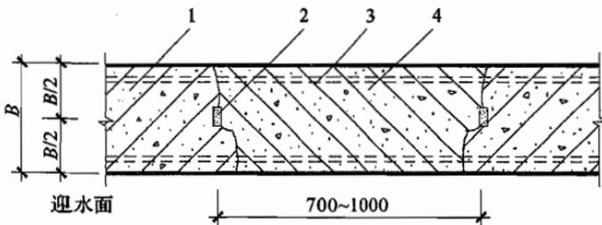
图 5.2.5-3 后浇带防水构造(三)
