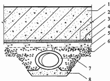
图 6.2.3 渗排水层构造
