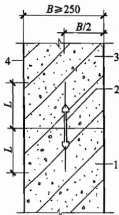
图 4.1.25-1 施工缝防水构造(一)
