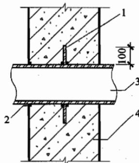
图 5.3.3-1 固定式穿墙管防水构造(一)
