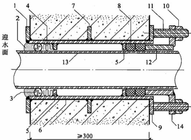
图 5.3.4 套管式穿墙管防水构造
