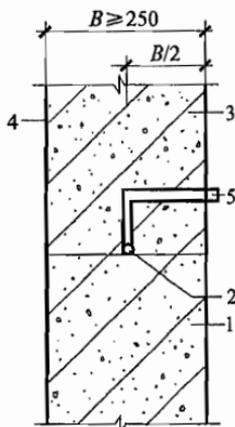
图 4.1.25-4 施工缝防水构造(四)
