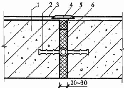
图 5.1.6-2 中埋式止水带与嵌缝材料复合使用
