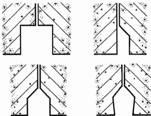
图 8.1.8 管片嵌缝槽断面构造形式
