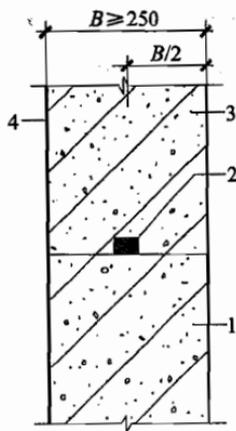
图 4.1.25-3 施工缝防水构造(三)
